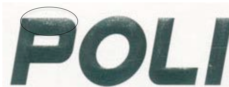
Figura 2. Desprendimiento del recubrimiento.
